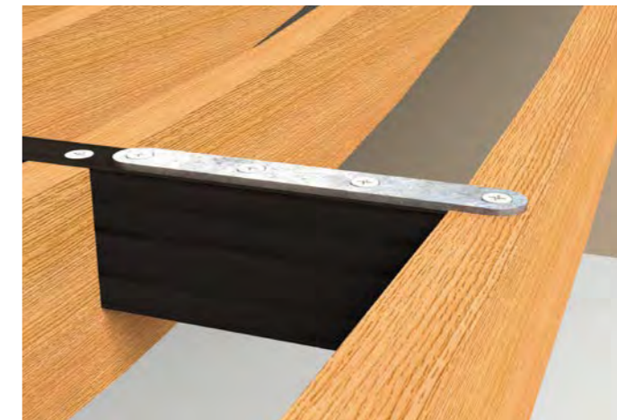
Étape 2 : Fixer la lame à l'aide de la patte d'assemblage et de ses 4 vis
