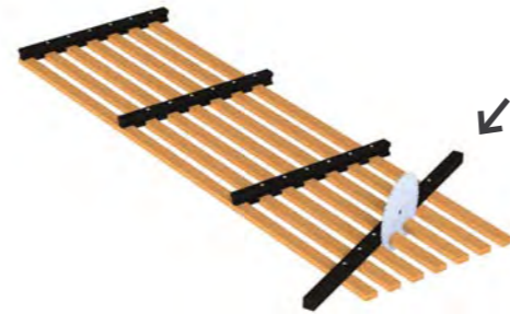
Étape 4 : Découper le panneau le long du profil de recoupe
