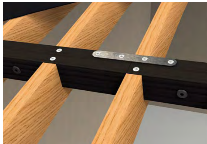
Étape 4 : Vérifier la bonne tenue de l'assemblage
