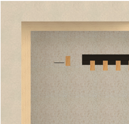
Etape 1 : Fixer la lame 20x42 mm sur le panneau
