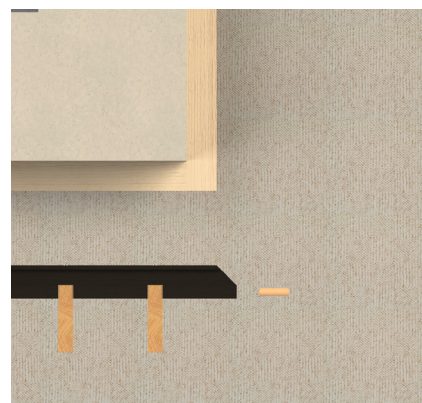
Étape 2 : Percer les contre-lattes et coller les tourillons
